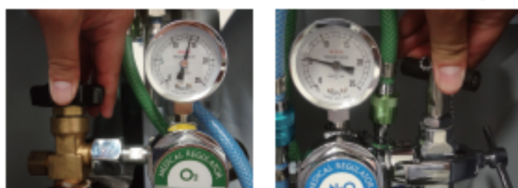
バルブをゆっくり開きガスの残量を確認
